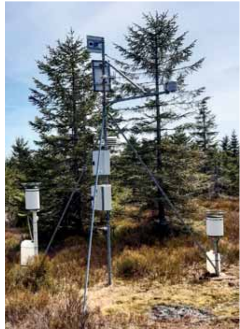
Obr. 1 Meteorologická stanice Rozmezí v Jizerských horách (995 m n. m.). Vlevo váhový srážkoměr MW7. Uprostřed automatická sněhoměrná stanice s ultrazvukovým čidlem na měření výšky sněhu. Vpravo člunkový srážkoměr MR3.
