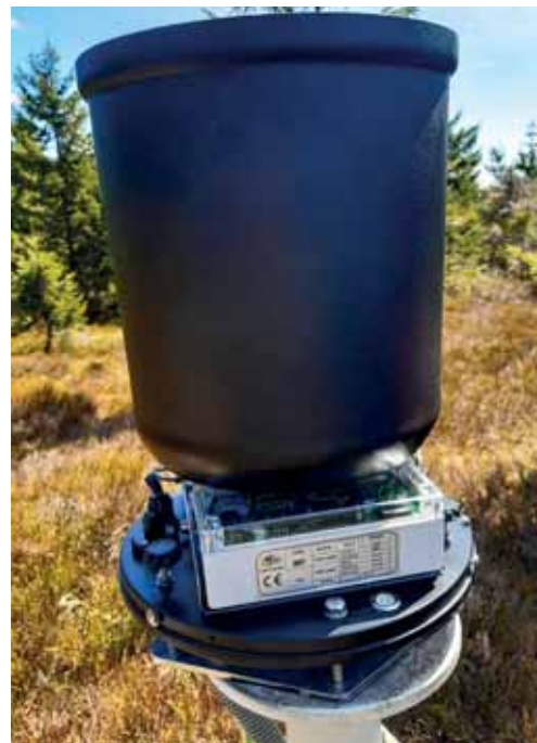
Obr. 2 Váhový srážkoměr Meteoservis MW7 v detailu: bez vnějšího ochranného pláště. Dole řídicí jednotka s váhou, na ní sběrná nádoba s čerpadlem.
